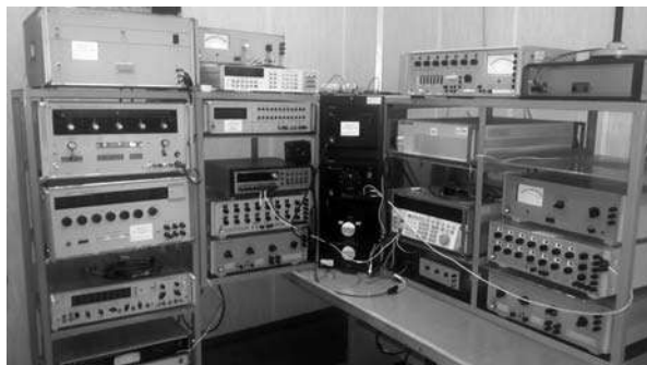
Рис. 1. Державний первинний еталон України одиниці змінного струму в діапазоні частот від 10 Гц до 1 МГц
