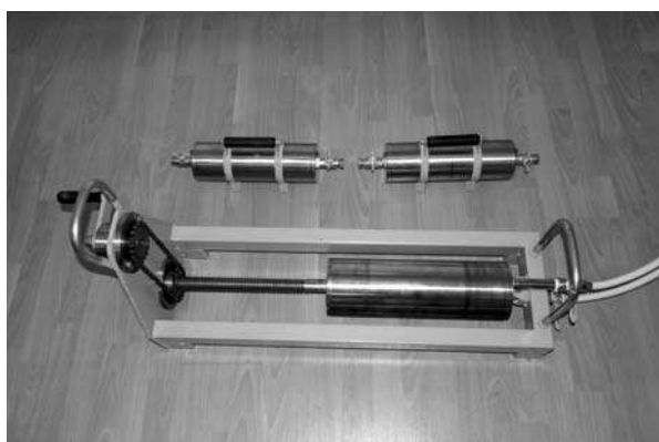
Рис. 1. Загальний вид поршневого пробовідбірника природного газу з двома балонами-пробовідбірниками Fig. 1. General view of the natural gas piston sampler with two balloons-samplers
