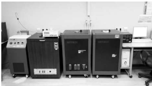
Рис. 1. Зовнішній вид вторинного еталона одиниці температури
