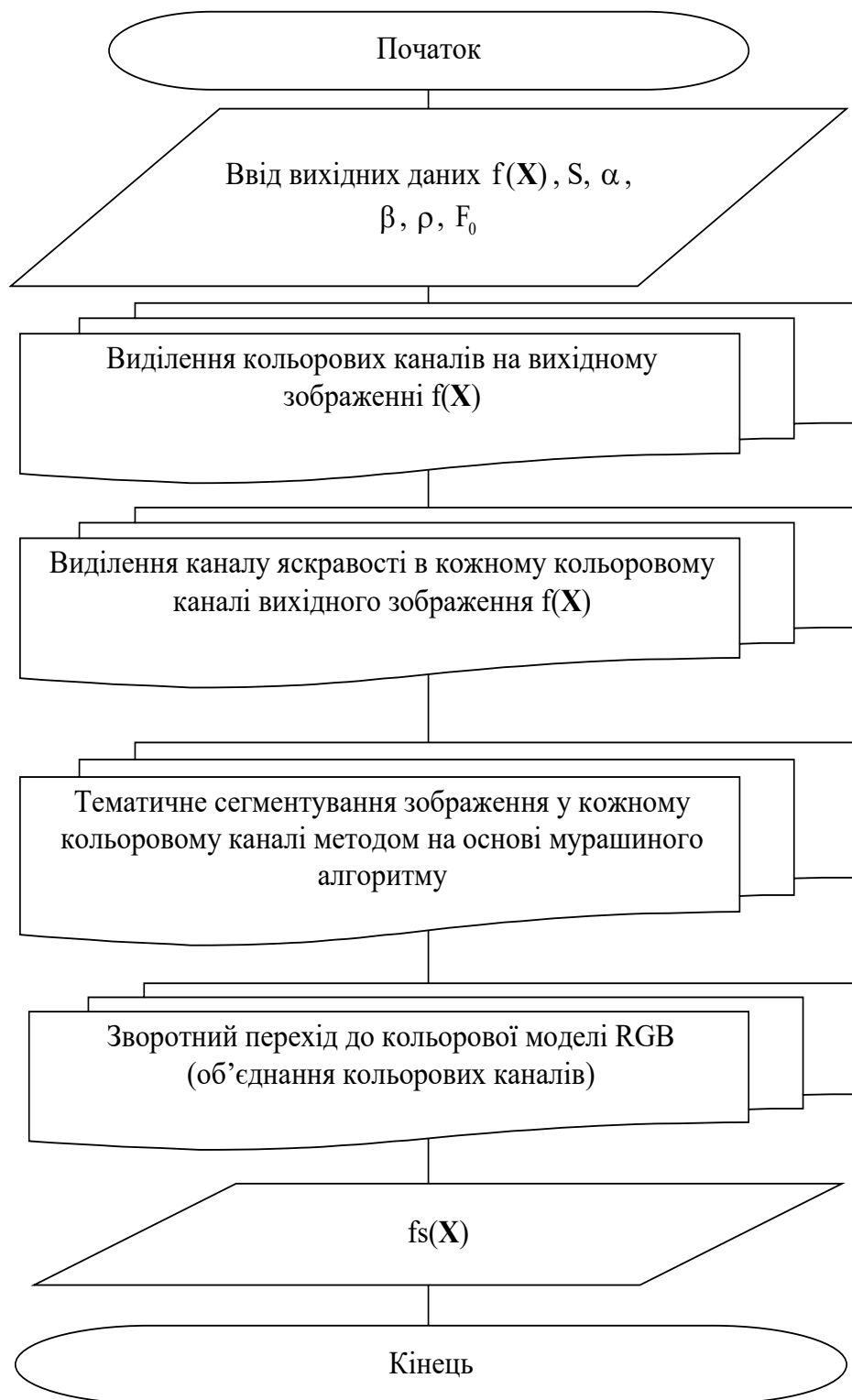
Рисунок 3.10 – Схема методу тематичного сегментування кольорового зображення (кольоровий простір RGB) бортової системи ОЕС на основі мурашиного алгоритму
