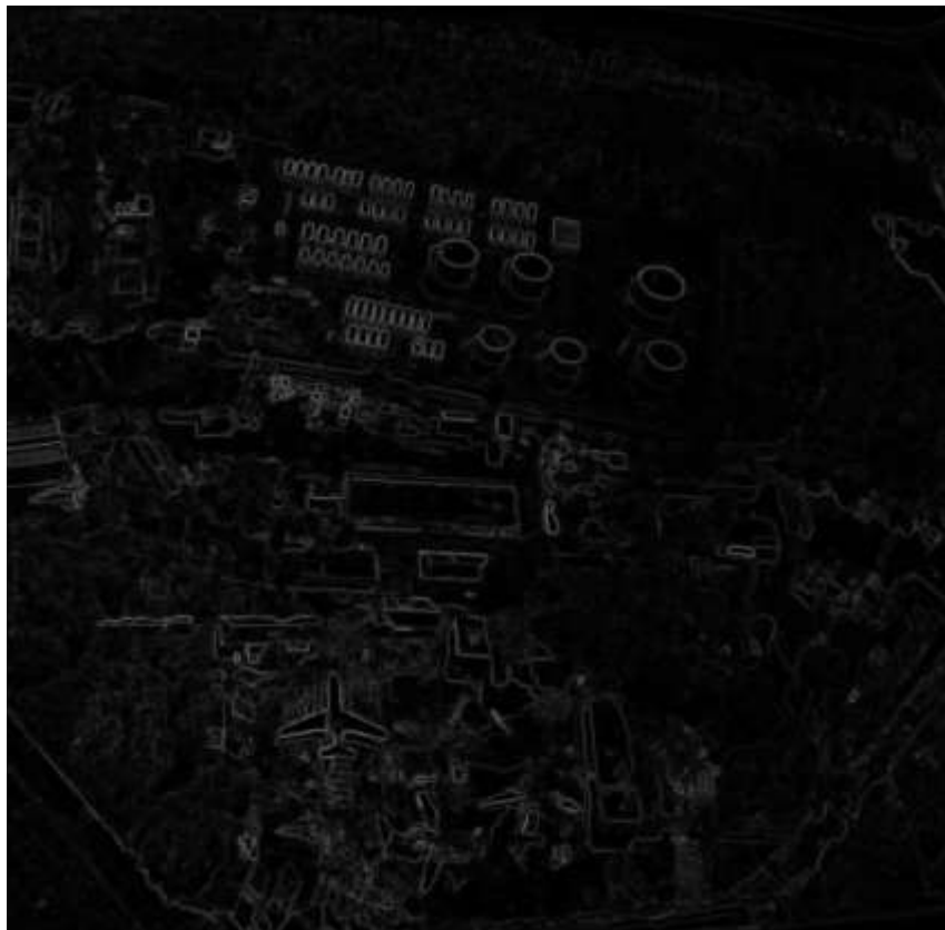
Рисунок 5.18 – Сегментоване ОЕЗ фільтром локальної дисперсії (вікно обробки 3x3))
