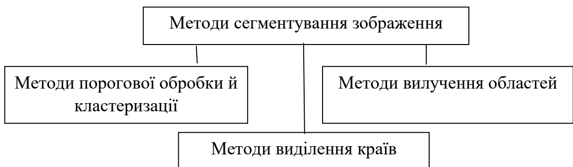
Рисунок 1.6 – Класифікація методів сегментування, що заснована на підході Фу [150]–[151]
