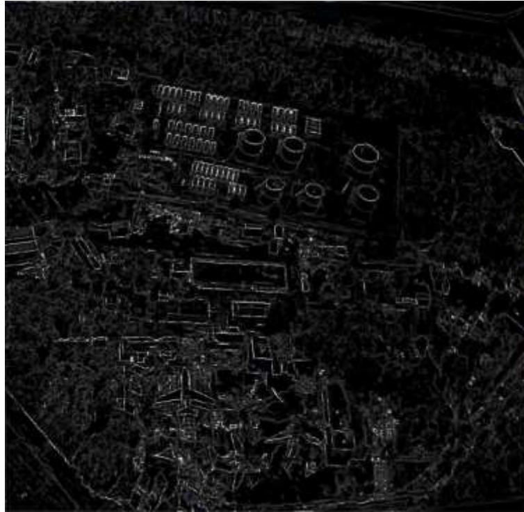
Рисунок 3.19 – Сегментоване зображення методом на основі мурашиного алгоритму з 1% елітних агентів
