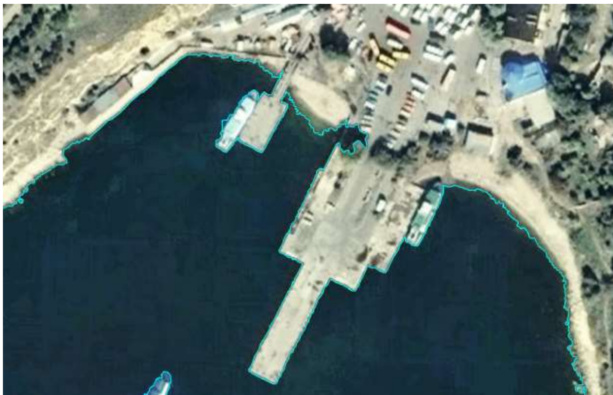
Рисунок В.11 – Результат автоматичної векторизації морського узбережжя методом ланцюгового коду
