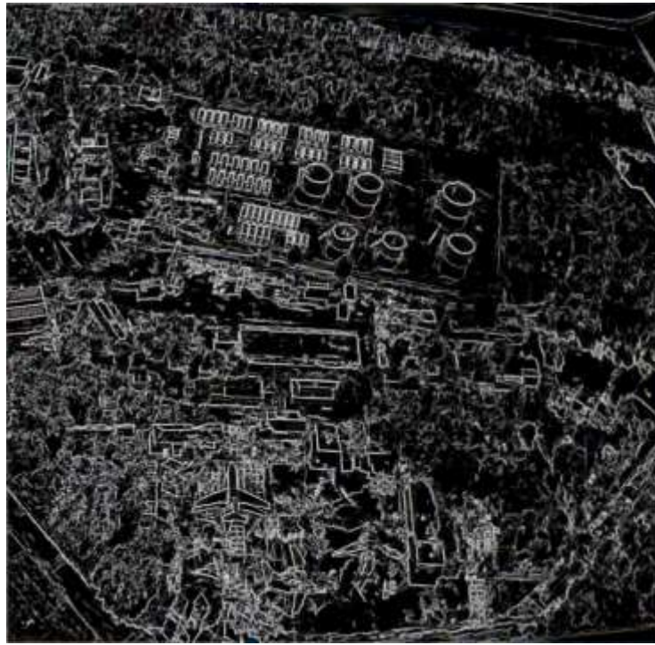
Рисунок 3.13 – Результат тематичного сегментування вихідного кольорового зображення (рис. 3.8) методом на основі мурашиного алгоритму
