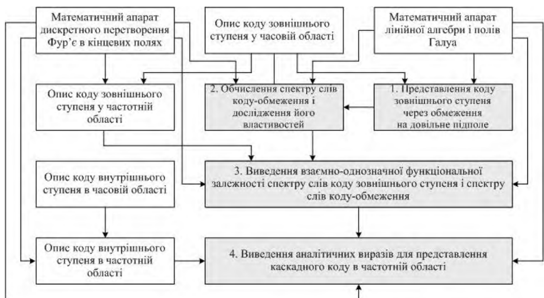
Рис. 4.6. Структурна схема пропонованого методу опису каскадних кодів в частотній області
