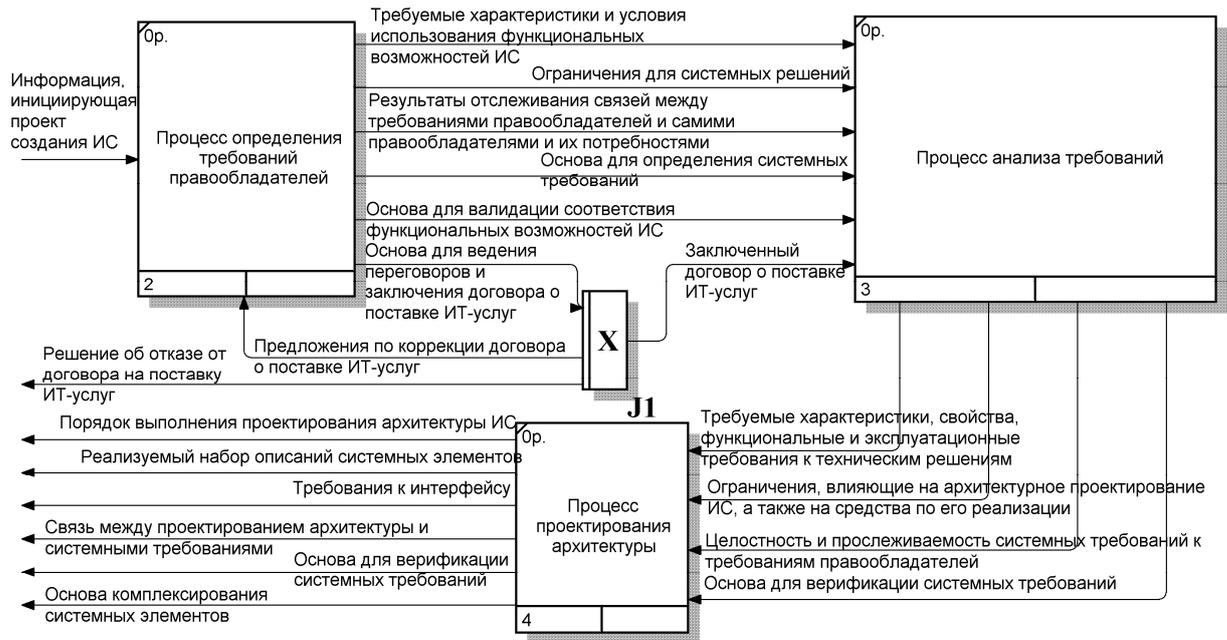
Рисунок 1.2 – IDEF3-модель взаимосвязи процессов жизненного цикла информационной системы, выполняемых в ходе ее макропроектирования
