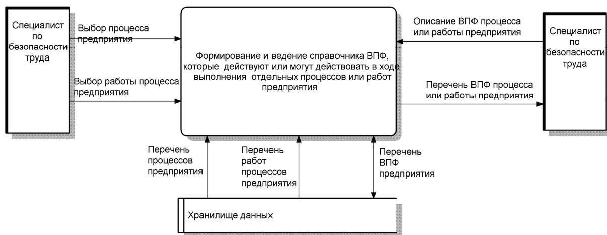
Рисунок 6.6 – Диаграмма потоков данных публикации третьего функционального требования к функциональному модулю безопасности труда на предприятии ПАО «Харьковгоргаз»
