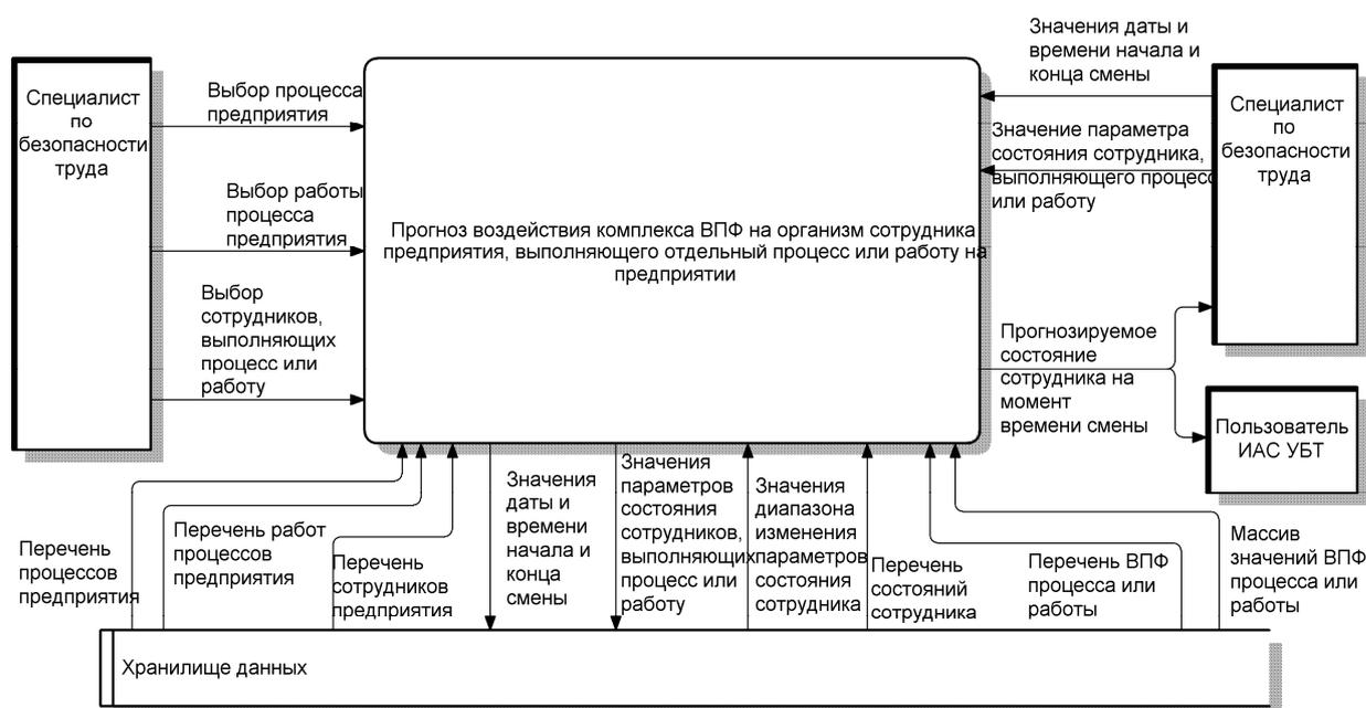
Рисунок 6.8 – Диаграмма потоков данных публикации пятого функционального требования к функциональному модулю безопасности труда на предприятии ПАО «Харьковгоргаз»
