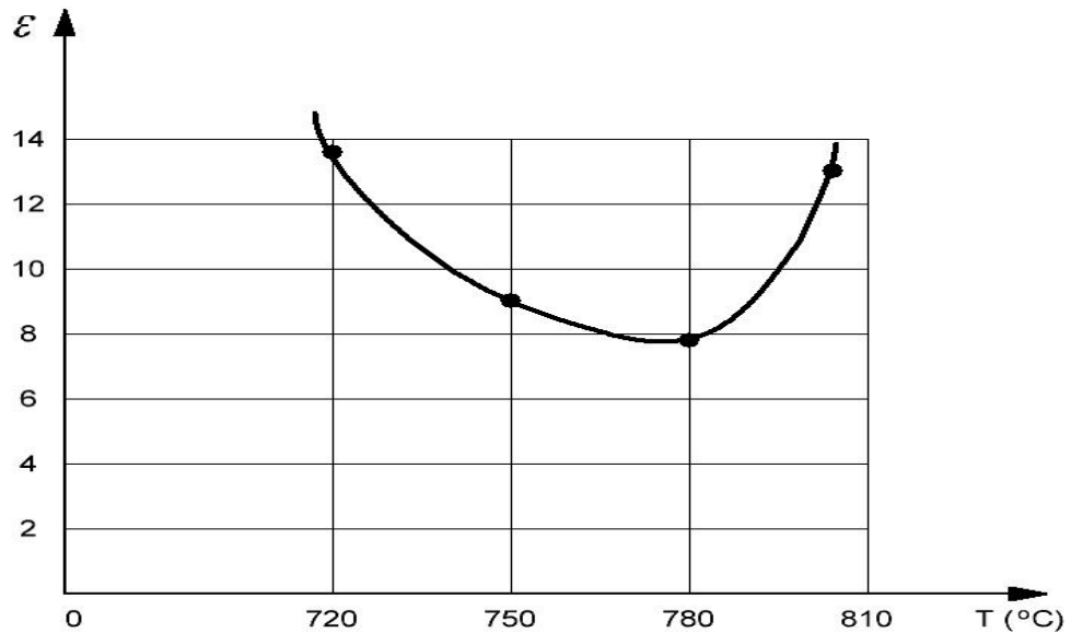
Рисунок 5.12 – Зависимость диэлектрической проницаемости от температуры вжигания стекла СЦ-273
