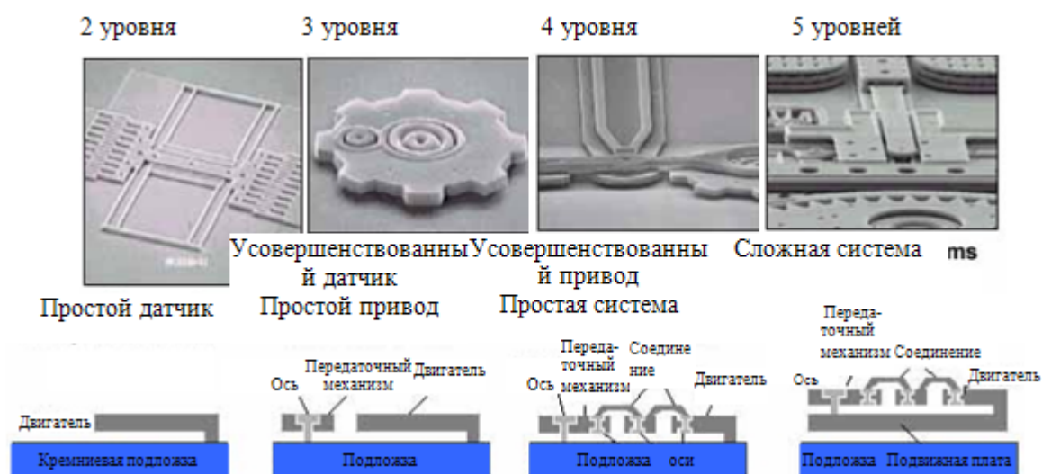
Рисунок 1. 13 – Сложность МСТ-устройств, определяемая структурными слоями
