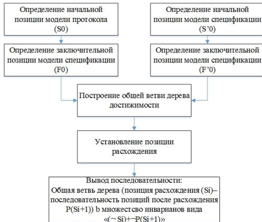
Рис. 3.4. Процесс построения контрпримера
