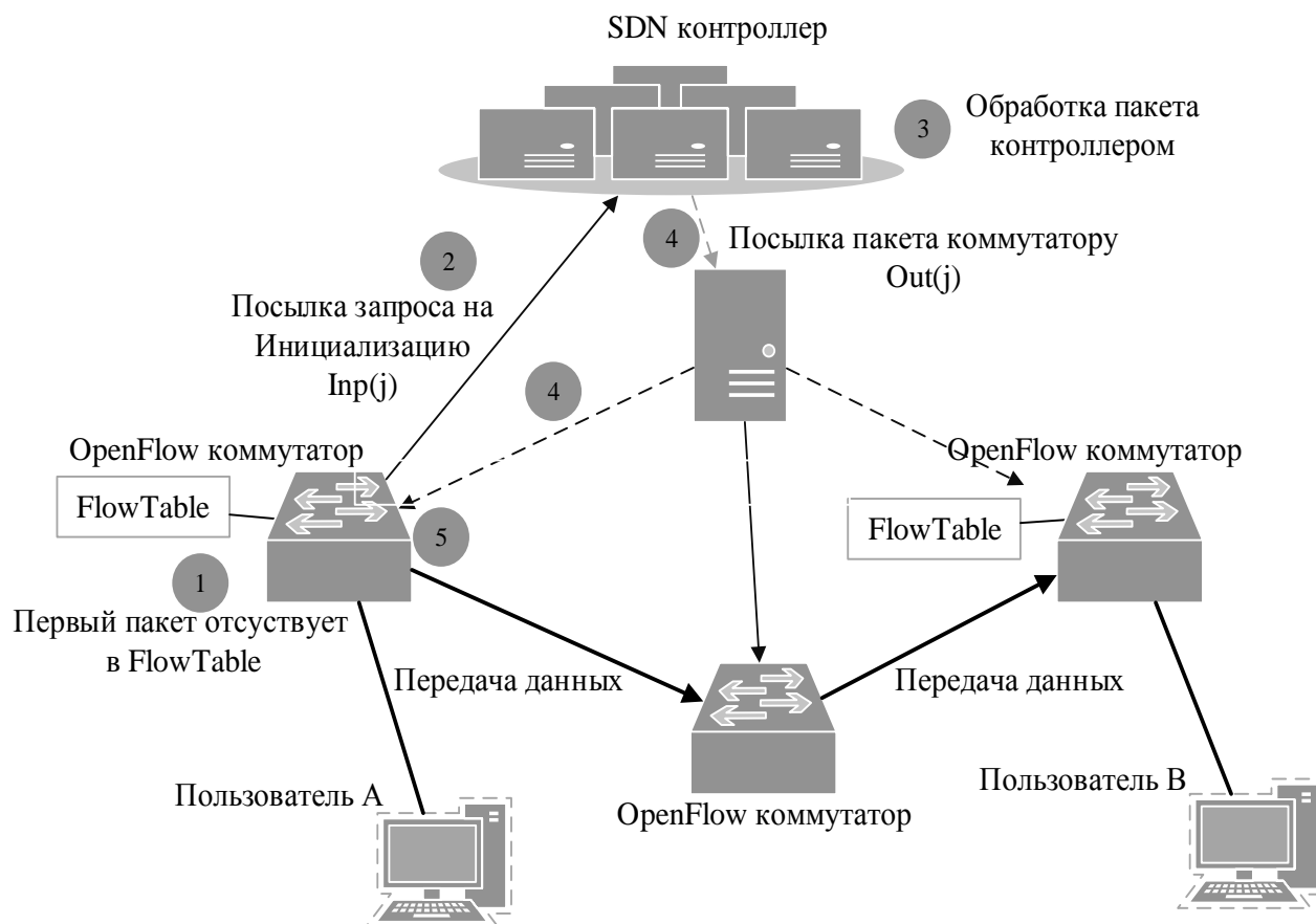
Рис. 2.4. Формирование управляющего потока в SDN
