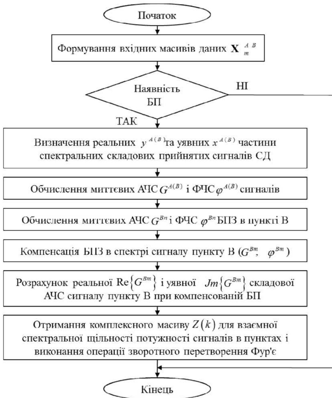
Рисунок 2.10–Алгоритм компенсації БП сигналу СД в частотній області
