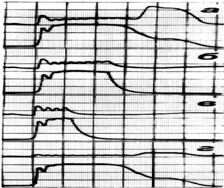
Рис. 3. Викривлення імпульсів ВЧ напруг резонатора і падаючих хвиль фідера, де лінійний прискорювач іонів збуджується ПК з ПЗЗ з фідером, на початку ВЧ тренування трубок дрейфу, забруднених атмосферними газами
