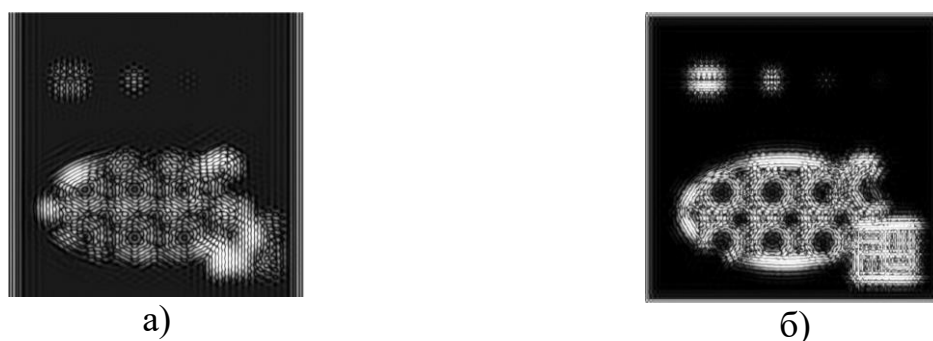
Рисунок 12 – Первинні РМЗ, отримані триелементною антенною системою: а) та дев'ятиелементною системою; б) ( f_0 = 3 \text{ ГГц} , \Delta f / f_0 = 0,01 )
