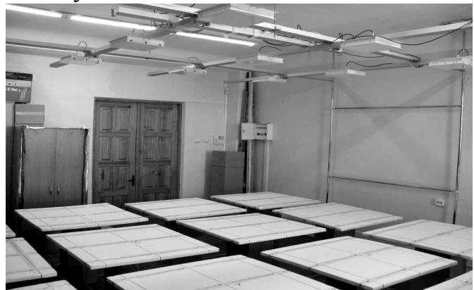
Рис. 4. Фотографія експериментальної установки для просторової RFID-локалізації
