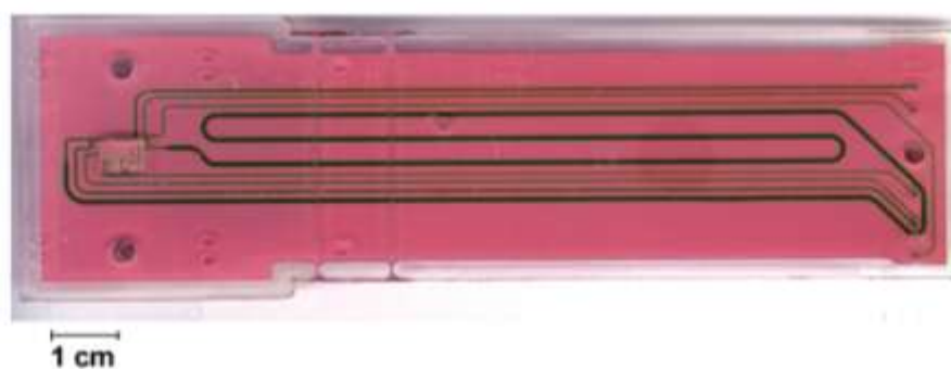
Рисунок 4.3 – Фотографія мікрофлюїдного картриджу, що інтегрувався у прилад Viacore 3000
