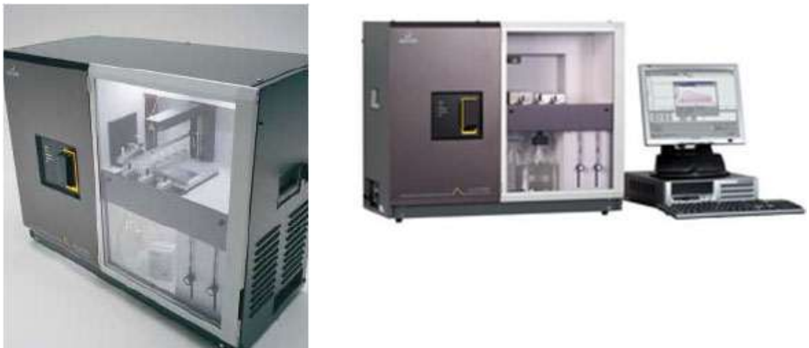
Рисунок 2.10 – Інтелектуальний ППР-сенсор «Viacore 3000»: ліворуч – сенсорний блок, праворуч – загальний вигляд
