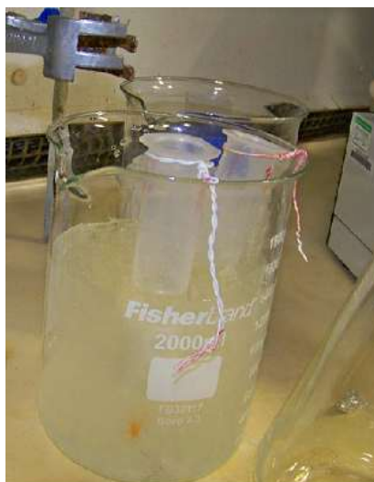
Рисунок 3.4 – Суміш після полімеризації у «Solid Face Extraction Cartridge» занурена у ємності з льодом
