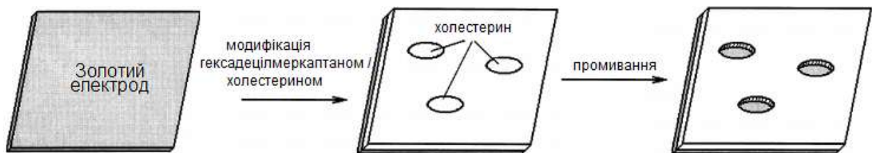
Рисунок 1.16 – Схематичне зображення показового підходу для отримання поверхневих відбитків [188]
