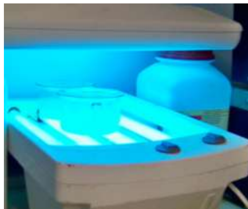
Рисунок 3.3 – Ємності для «Glass beads» з іммобілізованим темплатом в УФ-камері до (а) і під час полімеризації (б)
