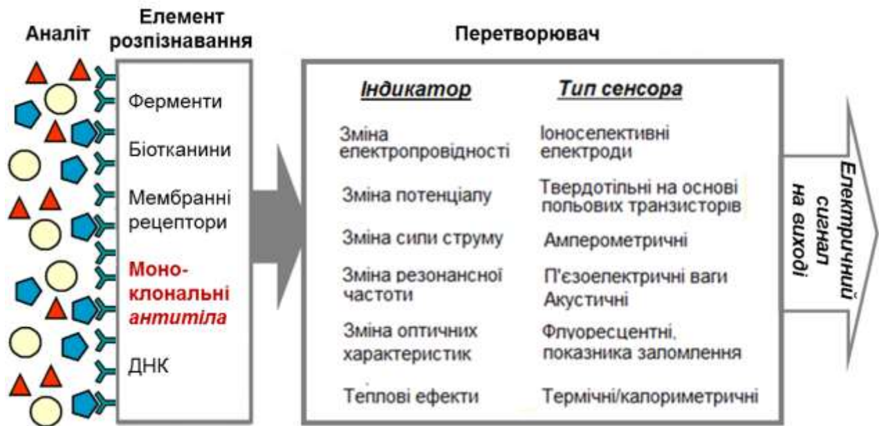
Рисунок 1.1 – Узагальнена принципова схема біосенсора
