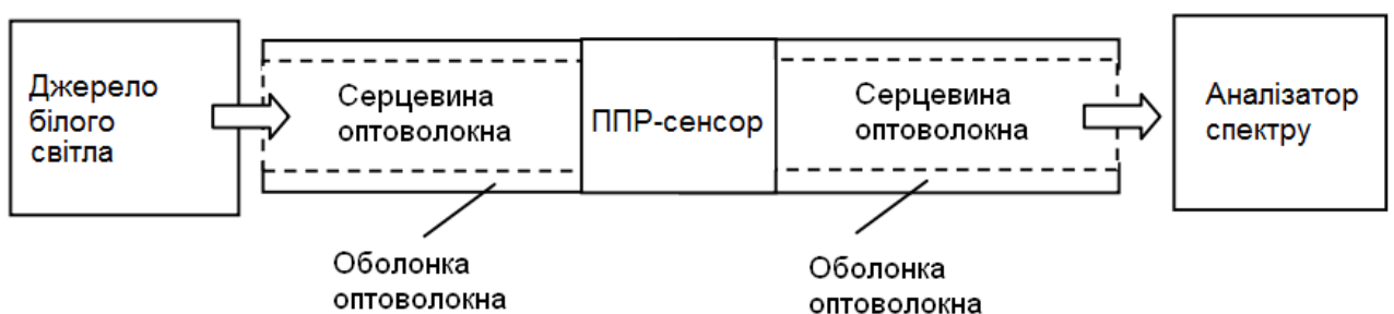
Рисунок 1.29 – Функціональна схема волоконно-оптичного ППР МП-сенсора
