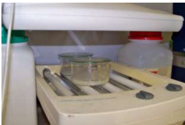
Рисунок 3.3 – Ємності для «Glass beads» з іммобілізованим темплатом в УФ-камері до (а) і під час полімеризації (б)
