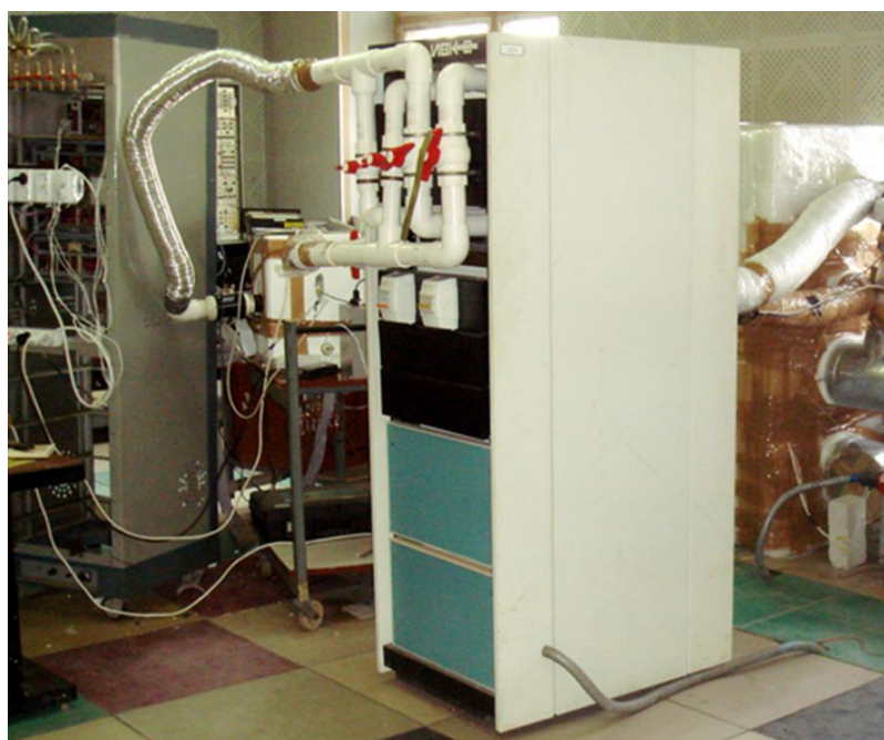
Рисунок 4.3 – Общий вид стенда для исследования характеристик охлаждения Li-ion батареи воздушным потоком
