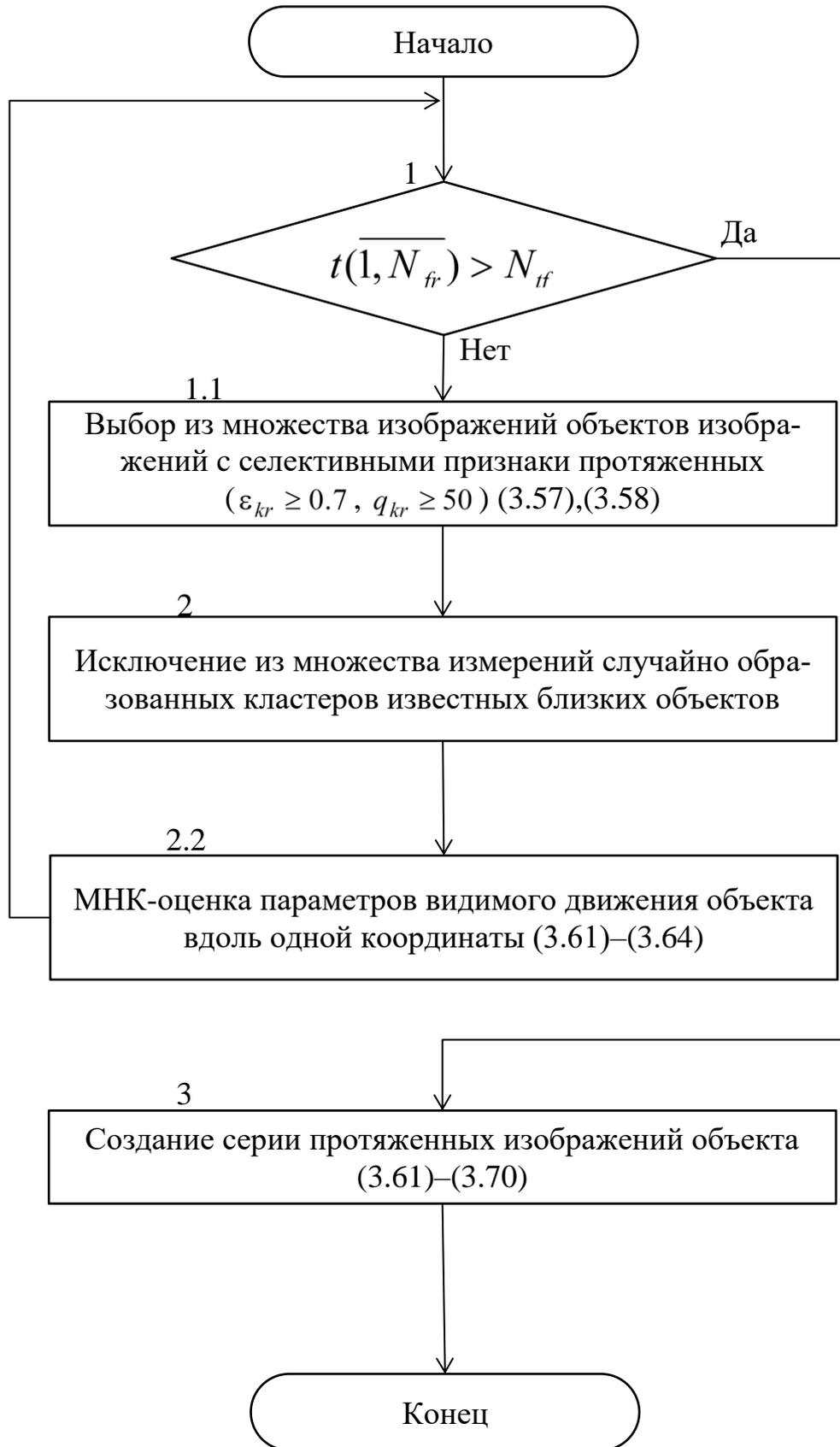
Рисунок 3.12 – Вычислительный метод обнаружения изображения объектов, смазанных собственным движением
