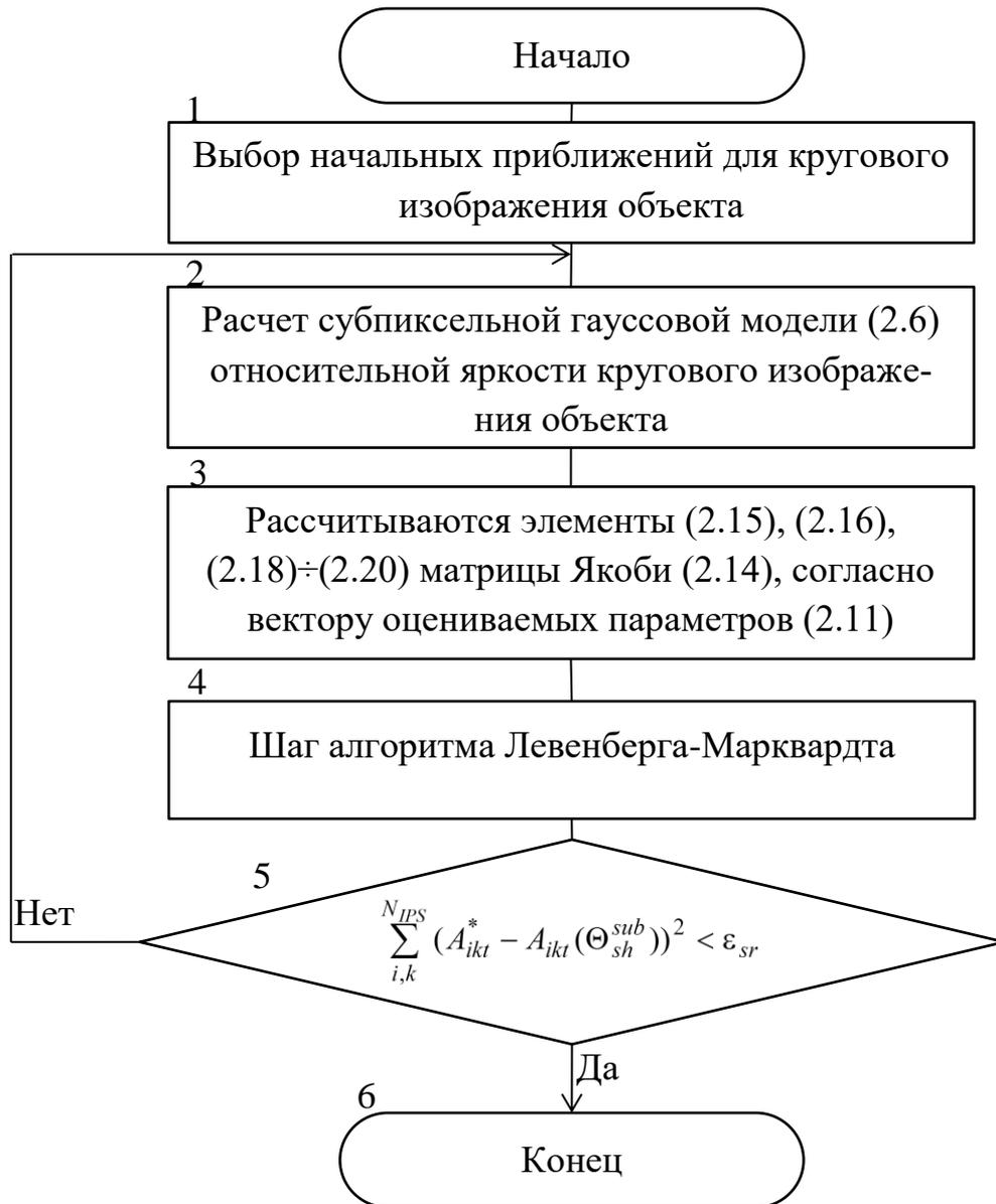
Рисунок 2.2 – Вычислительный метод определения параметров изображения круговых объектов согласно критерию минимума суммы квадратов отклонений между модельной и экспериментальной яркостями
