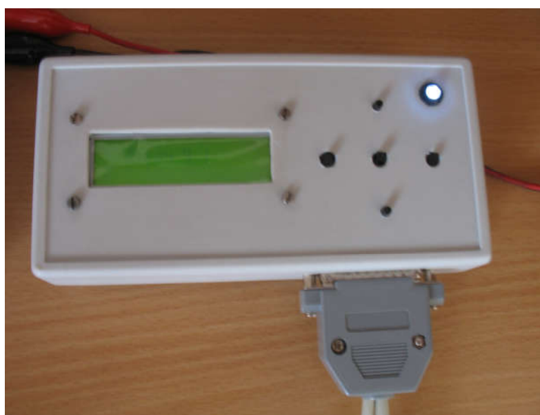
Рисунок 4.12 – Технічна реалізація індикаторного блоку з LCD-екраном
