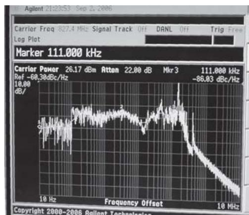
Рис. 4.13. Экспериментально измеренный спектр шума СВЧ автогенератора класса E, центральная частота 827 МГц
