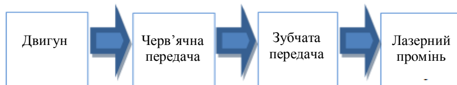
б) Конструкція системи передачі руху для позиціонування лазера (PL)
