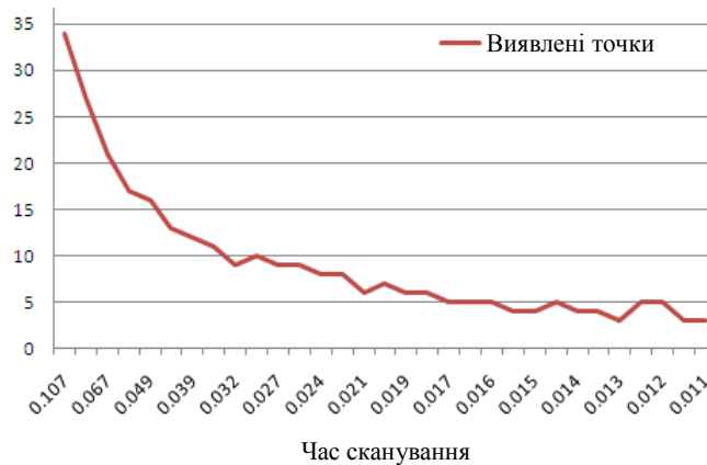
Рисунок 4.9, а) Кількість виявлених точок в залежності від часу сканування
