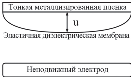
Рис. 1. Схема работы простейшей электростатической МЭМС
