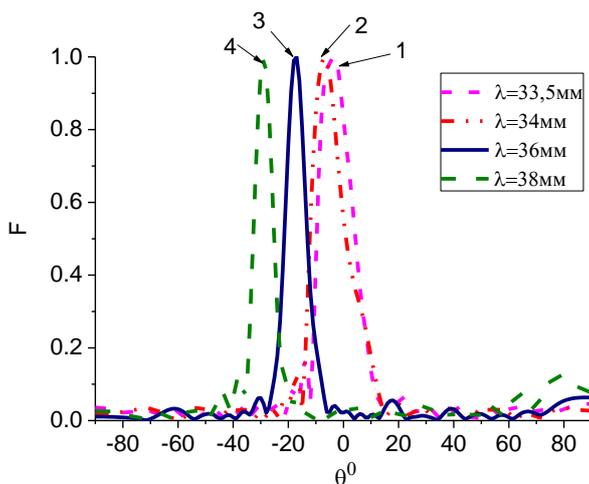
Рис. 6. Диаграммы направленности решетки N=20 поперечных щелей с синтезированной длиной излучателей для различных значений длин волн ( $\lambda = 33,5$  мм –  $\lambda = 38$  мм)
