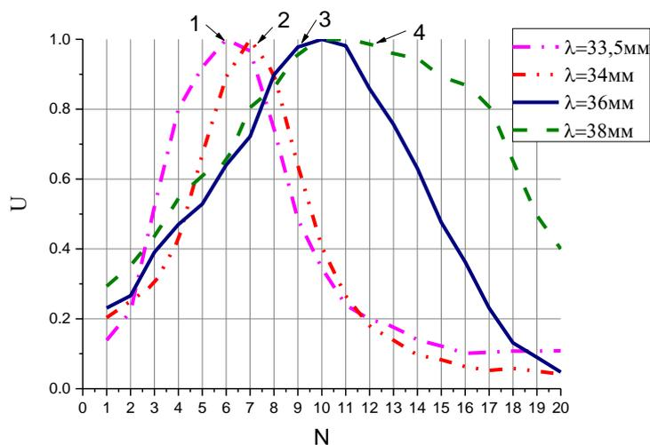
Рис. 5. Амплитудные распределения решетки N=20 поперечных щелей с синтезированной длиной излучателей для различных значений длин волн ( $\lambda = 33,5$  мм –  $\lambda = 38$  мм)
