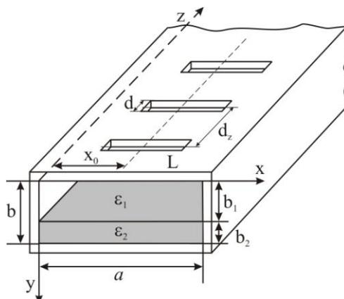
Рис. 1. Антенная решетка с поперечными щелями в волноводе со слоистым диэлектрическим заполнением
