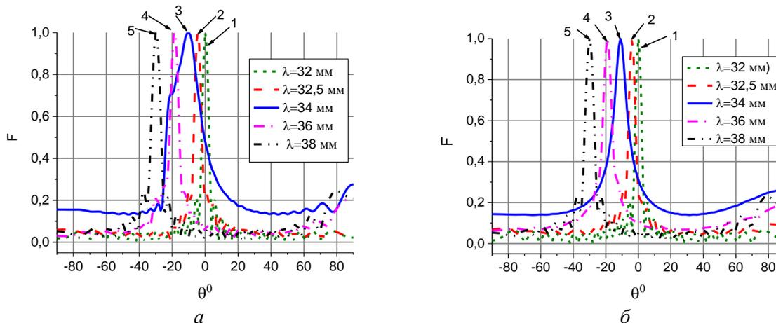
Рис. 4. Диаграммы направленности решетки N=20 поперечных щелей с одинаковой длиной излучателей L=16 мм для различных значений длин волн ( $\lambda = 32$  мм –  $\lambda = 38$  мм)
