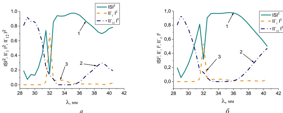
Рис. 2. Зависимость энергетических характеристик системы поперечных щелей одинаковой длины  $L = 16$  мм от длины волны
