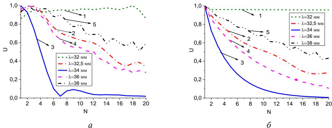
Рис. 3. Амплитудные распределения решетки N=20 поперечных щелей с одинаковой длиной излучателей L=16 мм для различных значений длин волн ( $\lambda = 32$  мм –  $\lambda = 38$  мм)
