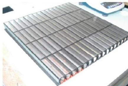
Макетный образец солнечного концентраторного модуля на линейных линзах Френеля разработок ГП НИТИП, Харьков, Украина, 2013 г.
