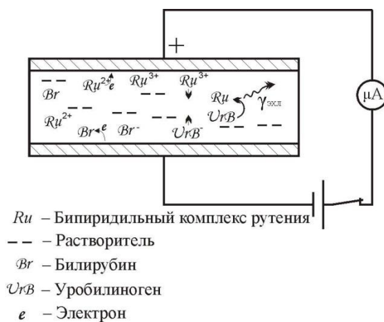
Рис. 2. Процессы, происходящие в системе при подаче напряжения на электроды
