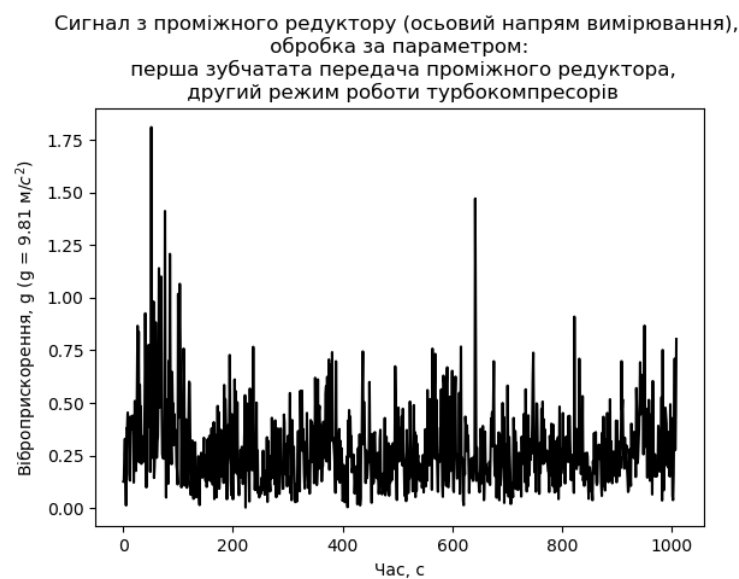
Рисунок 2.6 – Сигнал отриманий на проміжному редукторі (осьовий напрям вимірювання) та оброблений для отримання значень за параметром віброперевантаження першої зубчататої передачі проміжного редуктора на другому режимі роботи турбокомпресорів
