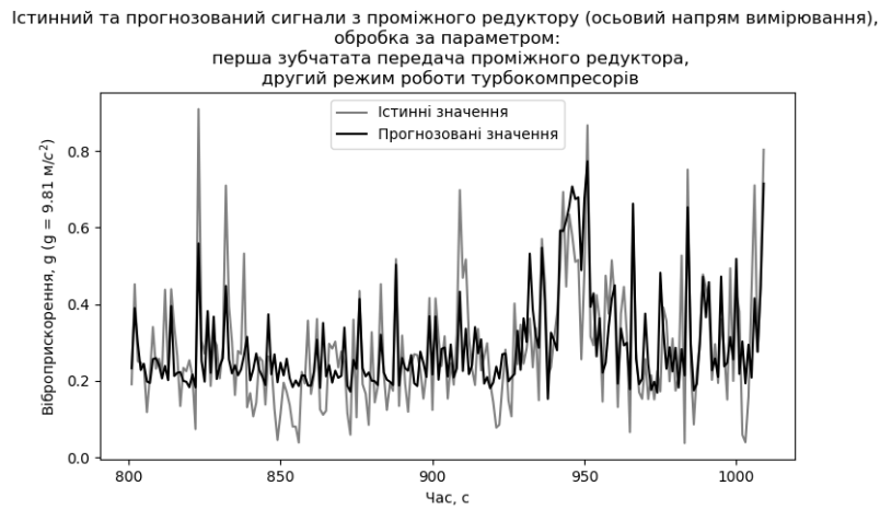
Рисунок 3.2 – Істинний та прогнозований сигнали отримані на проміжному редукторі (осьовий напрям вимірювання) та оброблений для отримання значень за параметром віброперевантаження першої зубчататої передачі проміжного редуктора на другому режимі роботи турбокомпресорів
