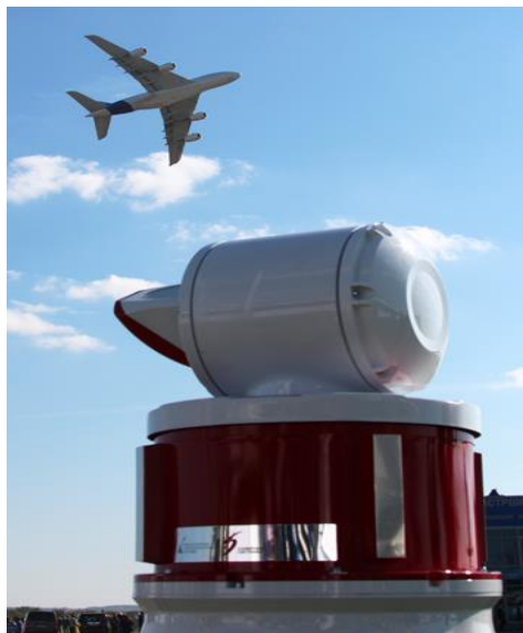
Рисунок 1.3 – Імпульсний вітровий лідар нового покоління ПЛВ-2000
