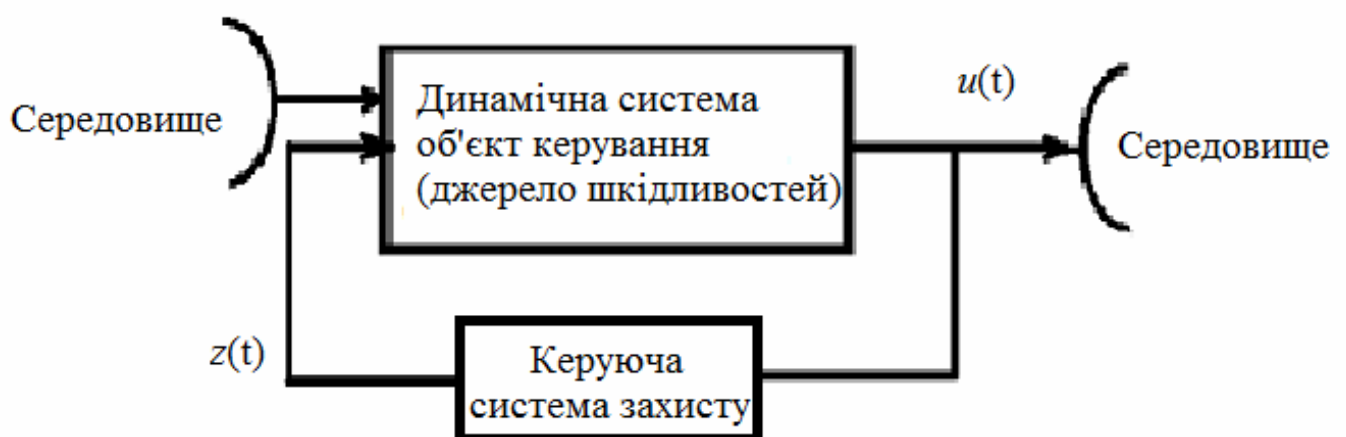
Рисунок 1.1 – Система із захистом як реалізація управління з негативним зворотним зв'язком
