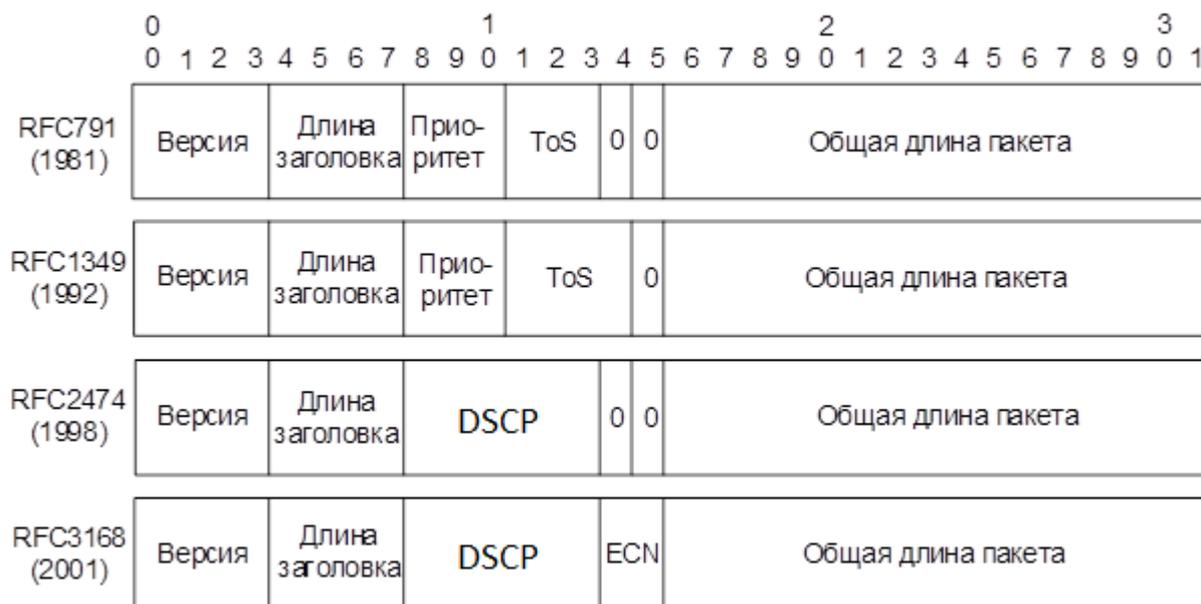
Рис. 1.6. Размещение полей DSCP и IP Precedence в заголовке IP-пакета
