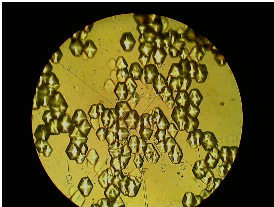
Рисунок 4.39 – Группы дислокаций в пластине GaAs. Оптический микроскоп МИИ-4. Увеличение 400 х.
