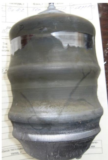
Рисунок 6.2 – Слитки GaAs диаметром 4//: а) – установка «Арсенид»; б) «Арсенид 1».
