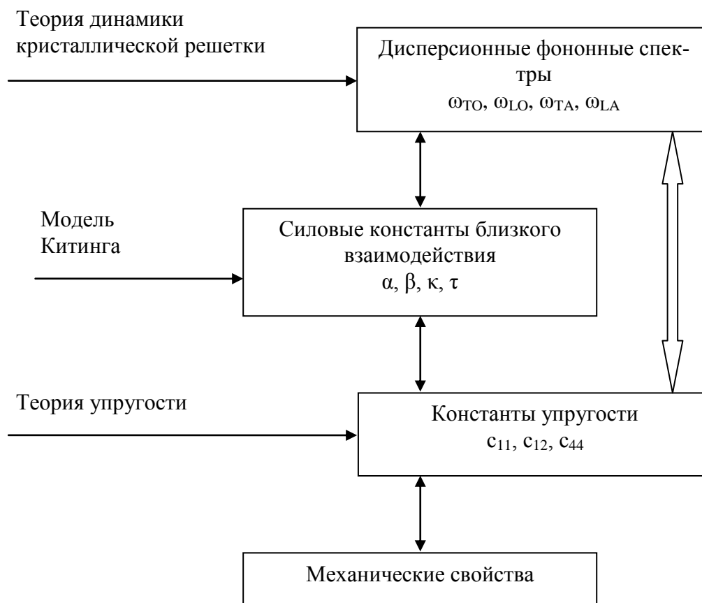
Рисунок 2.13 – Структурная схема моделирования влияния упругих констант на механические свойства GaAs.
