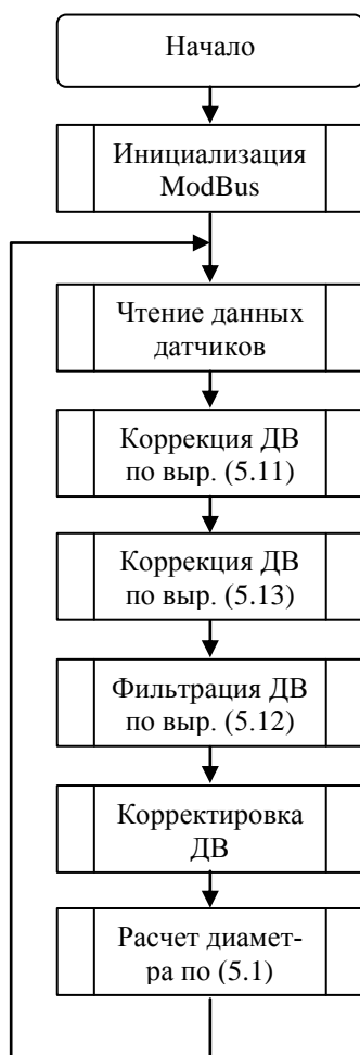
Рисунок 5.7 – Алгоритм работы устройства измерения диаметра слитка GaAs.
