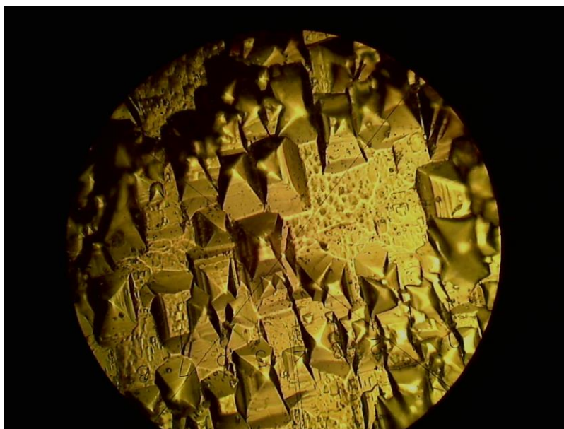
Рисунок 3.6 – Результат травления подложки арсенида галлия АГЧХ-98,0-650-(100) ориентации \{100\} травителем №1, время травления 240 сек, температура травления 70^{\circ}\text{C} . Увеличение 400^{\times}
