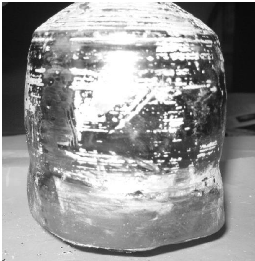
Рисунок 5.11 – Слиток GaAs, диаметр которого измерялся разработанным устройством с использованием предложенного метода.
