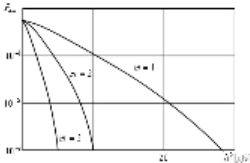
Рис. 3.4. Залежність ймовірності помилки P_{err} від співвідношення рівня сигналу до спектральної потужності шуму h^2
