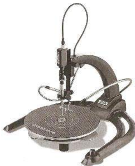
Рисунок 5.6 – Установка ERSASCOPE Inspection System 3000
