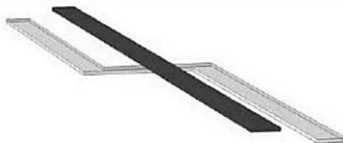
Рисунок Е.2 – Утворення паразитного зв'язку між провідниками
