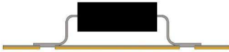
Рисунок 3.15 – З'єднання елемента за допомогою зварювання
