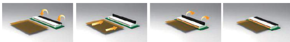
а) принцип роботи заціпки з'єднувача FPC
