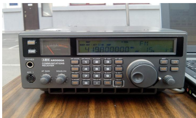
Рисунок В.3 – Скануючий приймач AR5000A
