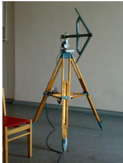
Рисунок В.4 – Еталон щільності потоку енергії ВЕ ЗСУ 09-00-05-09
