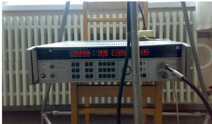
Рисунок В.1 – Генератор сигналів високочастотний РГ4-08
