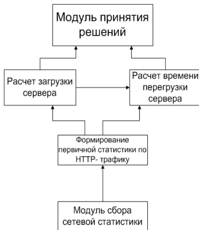
Рис. 4.5. Функциональная схема системы обнаружения Slow HTTP атак
