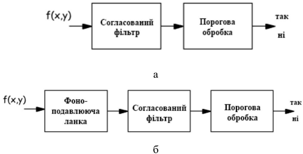
Рисунок 3.5 – Структури оптимальних детекторів зображення об'єкта на фоні завад: з рівномірним енергетичним спектром (а), з енергетичним спектром довільної форми (б)
