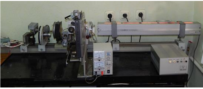
Рис. 10 – Пристрій вимірювання залишкових напружень «Полярон - 4»
