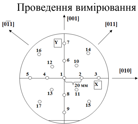
Рис. 18 – Схема вимірювання постійної решітки підкладки GaAs
