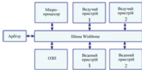
Рис. 7. Архітектура тестової системи на кристалі
