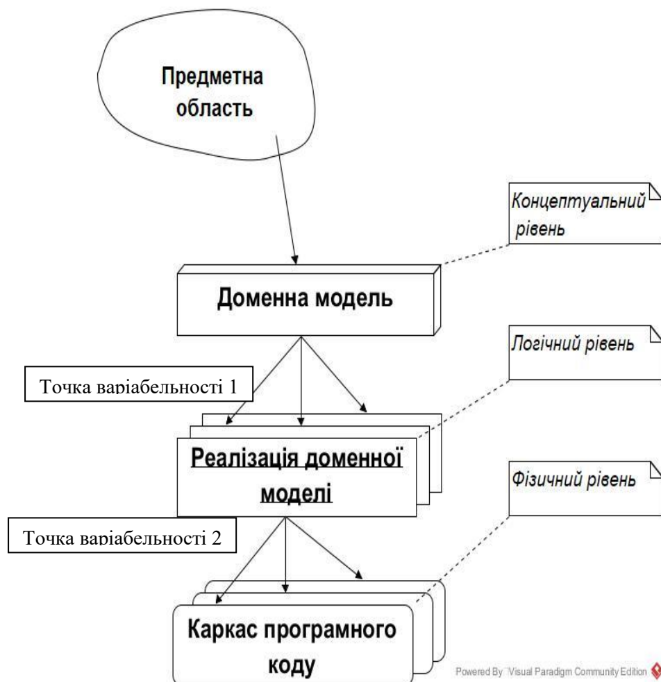
Рисунок 1.3 - 3-х рівнева схема застосування принципів доменного моделювання при розробці ПС
