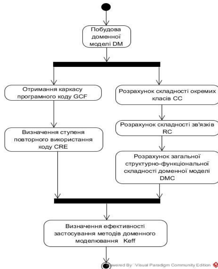
Рис. 3.4 - Процедура визначення коефіцієнту ефективності застосування методів доменного моделювання
